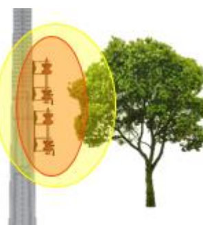
Figura 11 - Árvores ou galhos na ZONA DE CONTROLADA OU DE RISCO (Nível Baixa Tensão, Rede Secundária)
